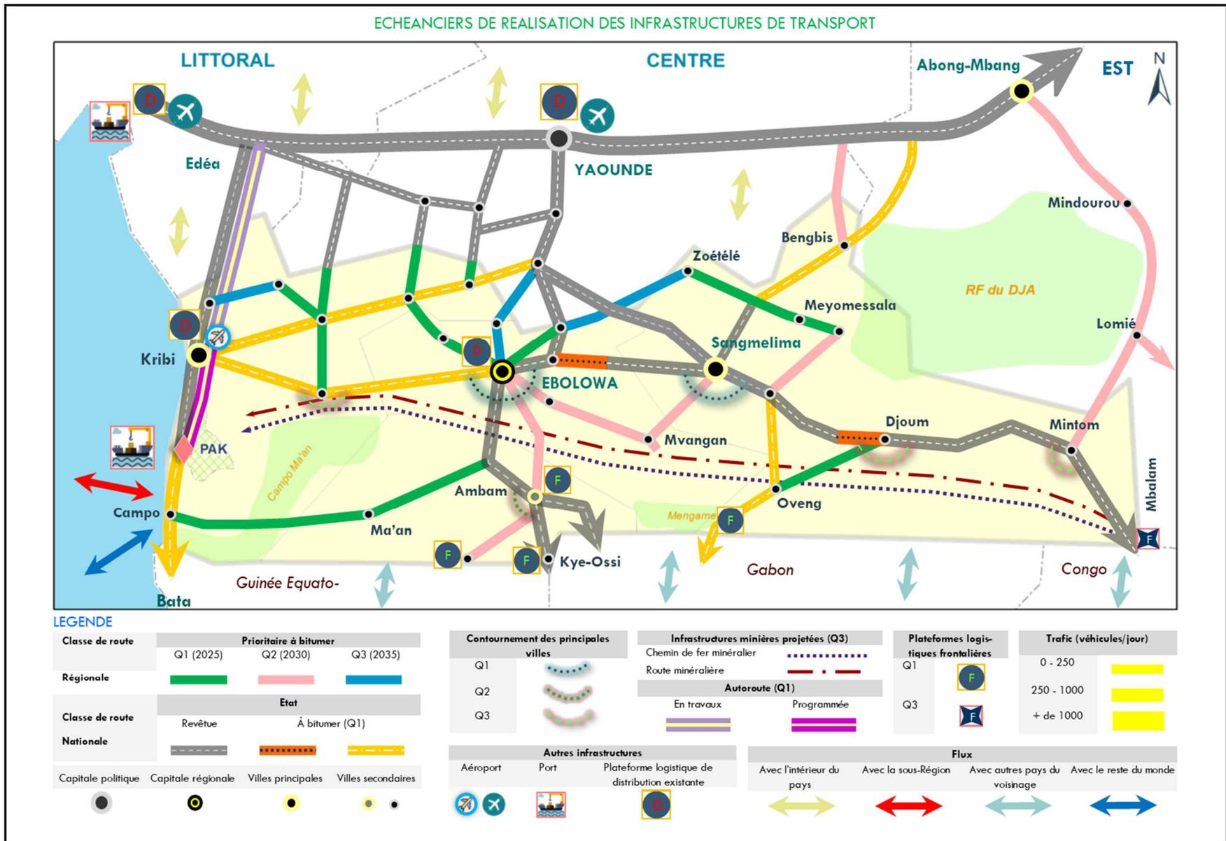
Figure 7: Planification des principales infrastructures de communication
